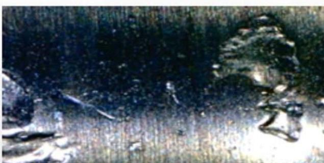
Поверхность подшипников в бортовом редукторе 793 самосвала, 18000 моточасов, наработка масла 4000 моточасов, **С ПРИМЕНЕНИЕМ СИСТЕМ ФИЛЬТРАЦИИ МАСЛА**
