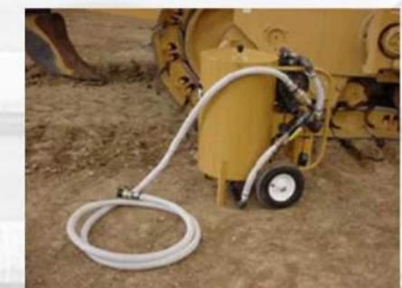
**Проект Ормет.** На проекте представлена самая широкая линейка фильтрационных устройств, от установки для сбора отработанного масла (номер 299-5610) до установки для фильтрации масла в бортовых редукторах бульдозеров (номер 231-6284). На регулярной основе чаще всего фильтруются мосты и гидравлическая система самосвалов CAT 777 и погрузчика CAT 992.
