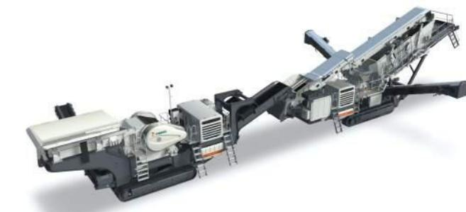
Штабели нерудного материала в районе МТО проекта Ориматтила обрабатываются в две смены. Негабарит сначала необходимо разрушить с помощью гидравлического молота, после чего выполняются две стадии дробления. Помимо мелкого гравия, конечный продукт включает в себя фракции размером 0–16 мм и 16–31 мм. При совместном использовании дизельного топлива и электроэнергии потребление топлива установилось на уровне около 60 литров. Для конусной дробилки GP330 установлен рабочий ход 27 мм.
